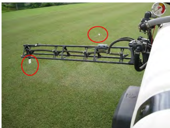
写真2 薬剤散布状況 タンク車の右側に伸ばしたアームから散布中、先端から白い泡を出してマーキング（赤丸印） 殺虫剤：フルスイング、殺菌剤：ランマン
