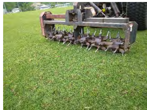
写真2 バイブロエアレーション アタッチメント部分「 タインを振動させて穴開けする
