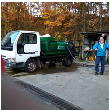
＜写真4＞大量散布用タンク車 機械が入れない部分もホースで散布 濃度を薄くして大量の水量で散布
