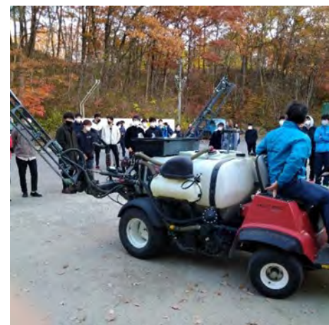
＜写真5＞少量散布用タンク車 ブームが開き車幅の3倍に散布 濃度を濃くして少量の水量で散布
