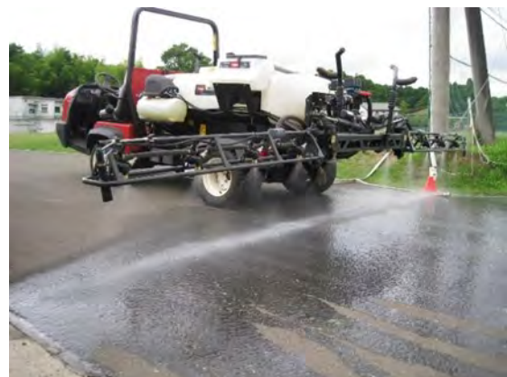
写真3 タンク内水洗い状況 タンク車の両側に伸ばしたアームと車幅のセンターアームから一斉にタンク車内の水を散水して洗浄中（薬剤散布と同じ状況）
