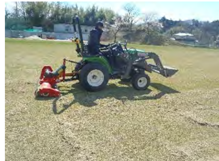
写真 4. バーチカルカット機械（外注）【近景】 トラクターの後にバーチカルカットアタッチメントを取り付けた専用機械による芝草の根切やサッチの掘り起こし状況
