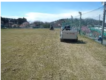
写真 5. スーパー機械（保有）【近景】 左側奥のバーチカル機械で起こした刈りカスなどを吸い込んで掃除する
