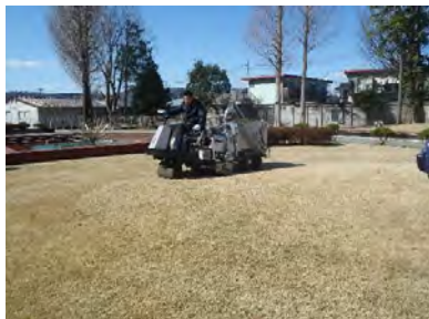
写真3. スーパー機械によるサッチ除去 【遠景】 サッチ：芝生の下層部と土壌表面との間に芝草の遺体や活力の衰えた部分、刈屑などが密に混じった堆積物。病虫害の多発など有害な作用が起こる。
